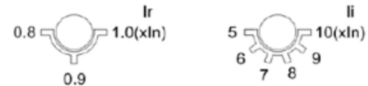
La función de protección contra sobrecarga proporciona una curva de límite de tiempo inversa basada en bimetálico. Si se excede el límite, la deformación del bimetálico puede hacer que se dispare el mecanismo de operación del interruptor. Rango térmico ajustable: 0.8, 0.9 y 1.0In.
